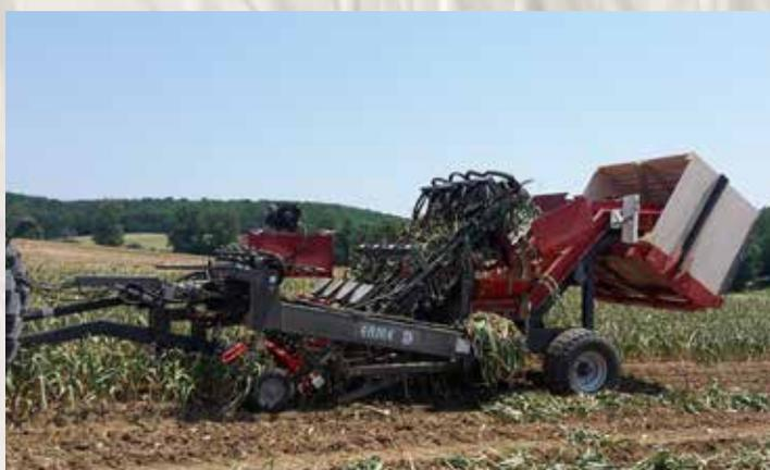
Equetage et mise en palox avec inclinaison automatique (pour éviter les chocs)
